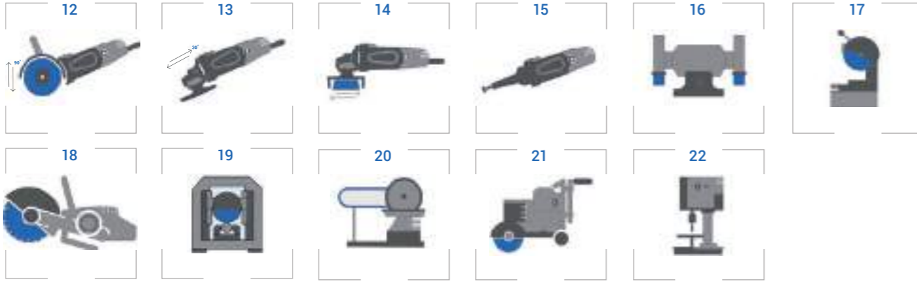
12 - Taşınabilir kesme motoru uygulaması 13 - Taşınabilir taşlama motoru uygulaması 14 - Çanak taşları için taşlama motoru uygulaması 15 - Saplı taşlar için taşlama motoru uygulaması 16 - Taşlama uygulaması 17 - Testere ile kesme uygulaması 18 - Benzinli kesme motoru uygulaması 19 - Sabit tezgah ile kesme uygulaması 20 - Sonsuz bant makinası uygulaması 21 - Beton kesme testeresi uygulaması 22 - Freze makinası uygulaması
