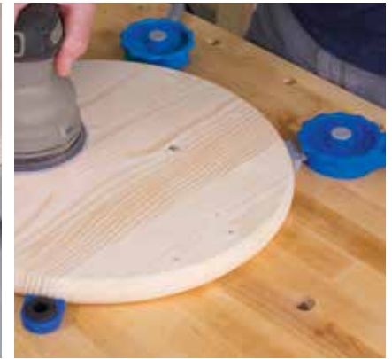
Kelepçe pabucu düz ve yuvarlak tutar. Yanı sıra 90°
