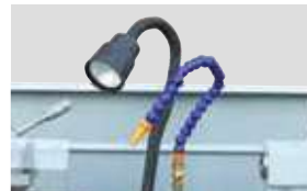
Aydınlatma Lambası & Soğutma Sistemi
