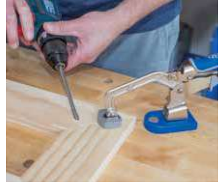
Tezgah mengenesi sıkı oturan bağlantılar oluşturmak için hizalanmış parçaları mükemmel şekilde tutar.
