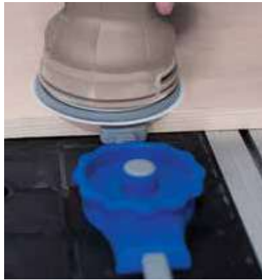
Düşük profilli tasarım kelepçeyi çalışma alanının dışında tutar.
